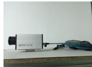
德国DIAS非制冷中红外热成像仪 PYROVIEW (3-5 \mu m, 384*288px1)
