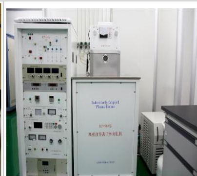
中科院微电子研究所ICP-98A型 高密度等离子体刻蚀机
