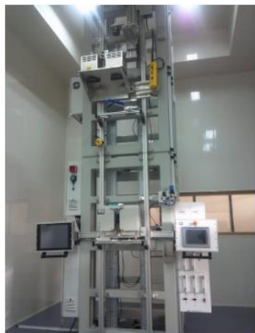
英国SG Controls 公司光纤拉丝塔
